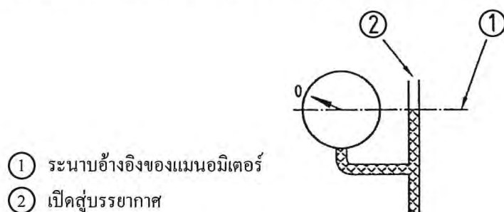
รูปที่ 11 การจัดเตรียมสำหรับการหาระนาบอ้างอิงของเกจวัดความดันแบบสปริง
